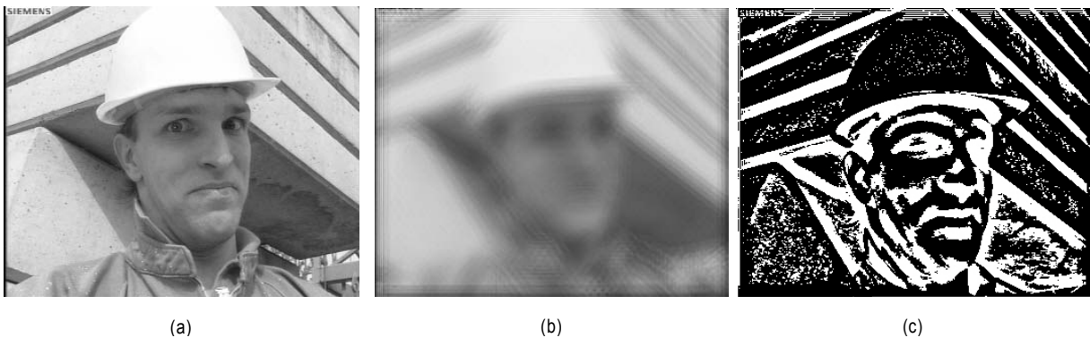
그림 4. (a) 원본 Foreman 영상 ( F ) (b) 제안한 알고리즘을 통해 얻은 영상 ( \hat{F} ) (c) 1비트 이진 영상 ( B ) Fig 4. (a) Original Foreman frame ( F ) (b) Foreman frame applied wavelet domain ( \hat{F} ) (c) Foreman frame applied one-bit transform ( B )
